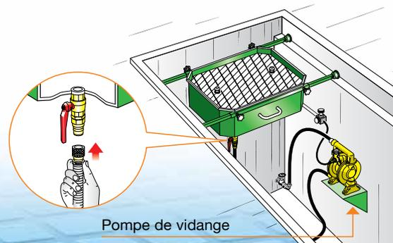
L'huile usée récupérée peut être transvasée du bac de récupération à la citerne de stockage par chute ou par aspiration à l'aide d'une pompe de vidange raccordée à l'installation fixe
