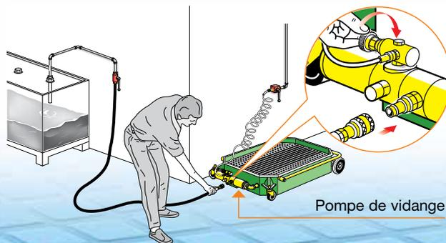
L'huile usée récupérée peut être transvasée du bac de récupération à la citerne de stockage par aspiration à l'aide de la sonde incorporée ou d'une pompe de vidange raccordée à l'installation fixe ou montée directement sur le bac.
